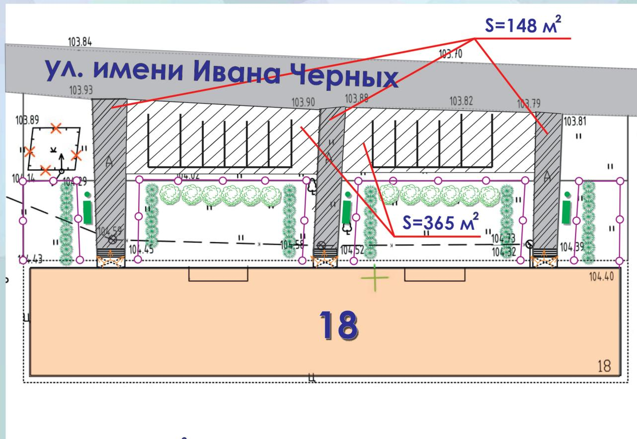
Устройство **365 м<sup>2</sup>** покрытия по парковкам из асфальтобетона
